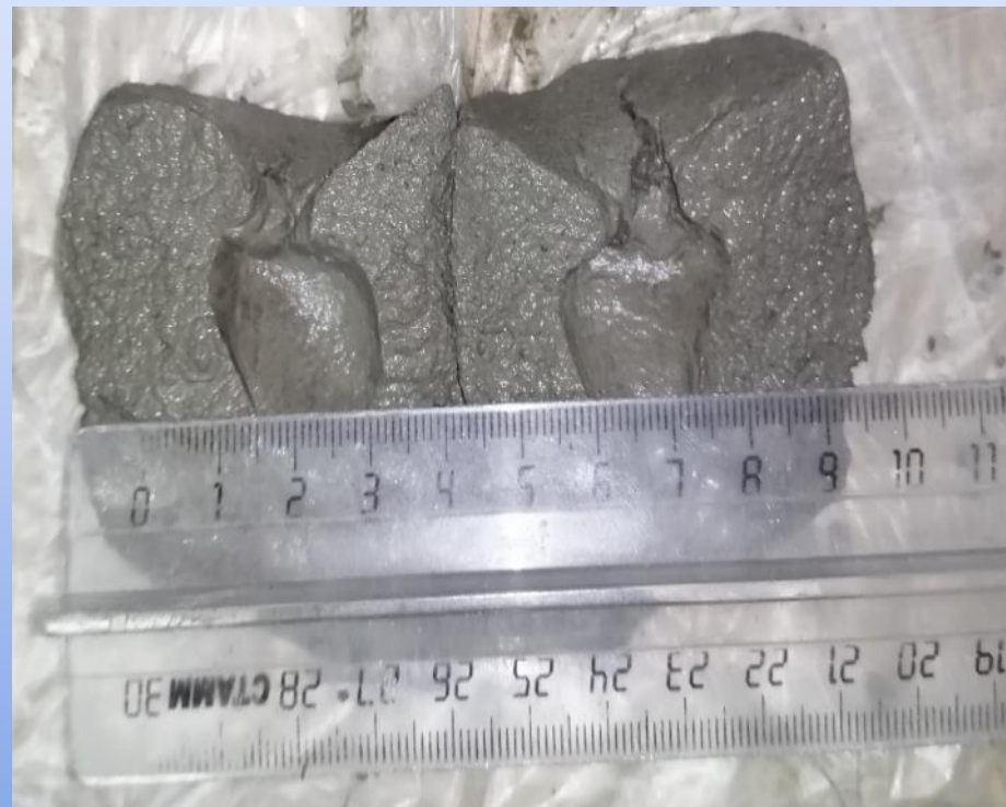
Экспериментально полученная форма и расположение зон давления вокруг искрового разряда
