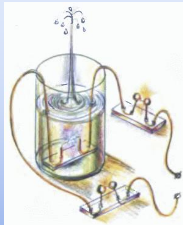
Схематическое изображение действия ЭГУ
